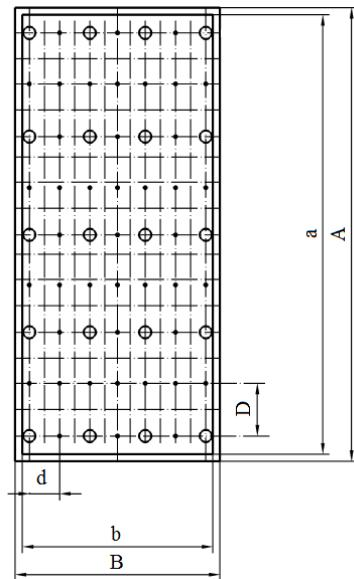
$A$  – длина расчетного поля;  $a$  – длина основной игровой зоны;  $B$  – ширина расчетного поля;  $b$  – ширина основной игровой зоны;  $D$  – шаг расчетных точек в продольном направлении;  $d$  – шаг расчетных точек в поперечном направлении
