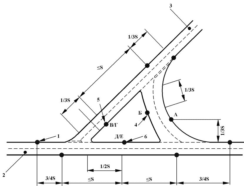
1 – положение светильников, 2 – главная дорога, 3 – второстепенная дорога, 4 – А и Б могут быть взаимоисключающими, но вариант Б является предпочтительным, 5 – В и Г могут быть раздельными или совмещеными, в зависимости от размера островка, 6 – Д и Е могут быть раздельными или совмещеными, в зависимости от размера островка, S – расчетный шаг установки светильников вдоль главной дороги
