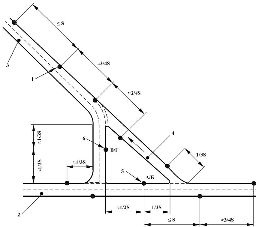
1 – положение светильников, 2 – главная дорога, 3 – второстепенная дорога, 4 – односторонняя перемычка, 5 – А и Б могут быть раздельными или совмещеными в зависимости от размера островка, 6 – В и Г могут быть раздельными или совмещеными в зависимости от размера островка, S – расчетный шаг установки светильников наружного электрического освещения вдоль главной дороги
