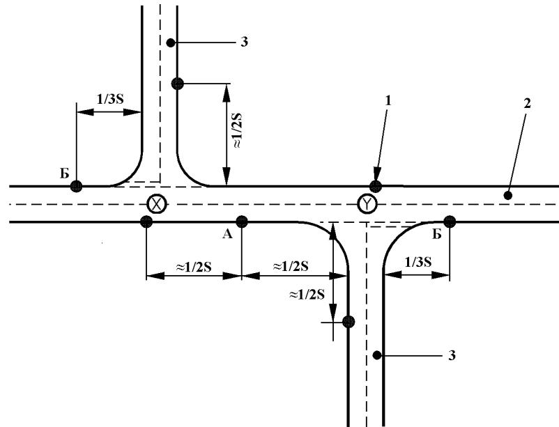
1 – положения светильников, 2 – главная дорога, 3 – второстепенная дорога, S – расчетный шаг установки светильников наружного электрического освещения вдоль главной дороги
