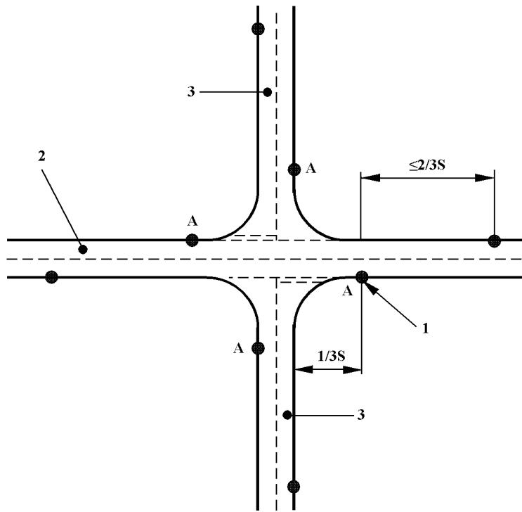
1 – положения светильников, 2 – главная дорога, 3 – второстепенная дорога, S – расчетный шаг установки светильников наружного электрического освещения вдоль главной дороги
