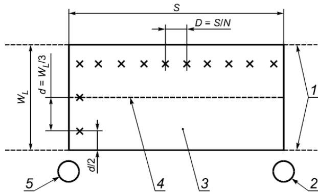
1 — край дороги; 2 — последний светильник на расчетном поле; 3 — расчетное поле; 4 — центральная линия дороги; 5 — первый светильник на расчетном поле; х — расчетные точки;  $W_L$  — ширина полосы;  $N$  — число расчетных точек;  $d$  — шаг расчетных точек в поперечном направлении;  $D$  — шаг расчетных точек в продольном направлении;  $S$  — шаг установки светильников
