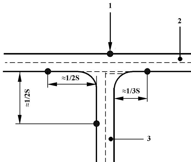
1 – положения светильников, 2 – главная дорога, 3 – второстепенная дорога, S – расчетный шаг установки светильников наружного электрического освещения вдоль главной дороги
