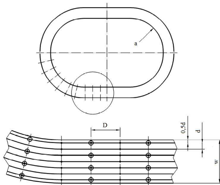
$a$  – внутренняя граница трека;  $D$  – шаг расчетно-измерительных точек в продольном направлении;  $d$  – шаг расчетно-измерительных точек в поперечном направлении;  $w$  – ширина трека
