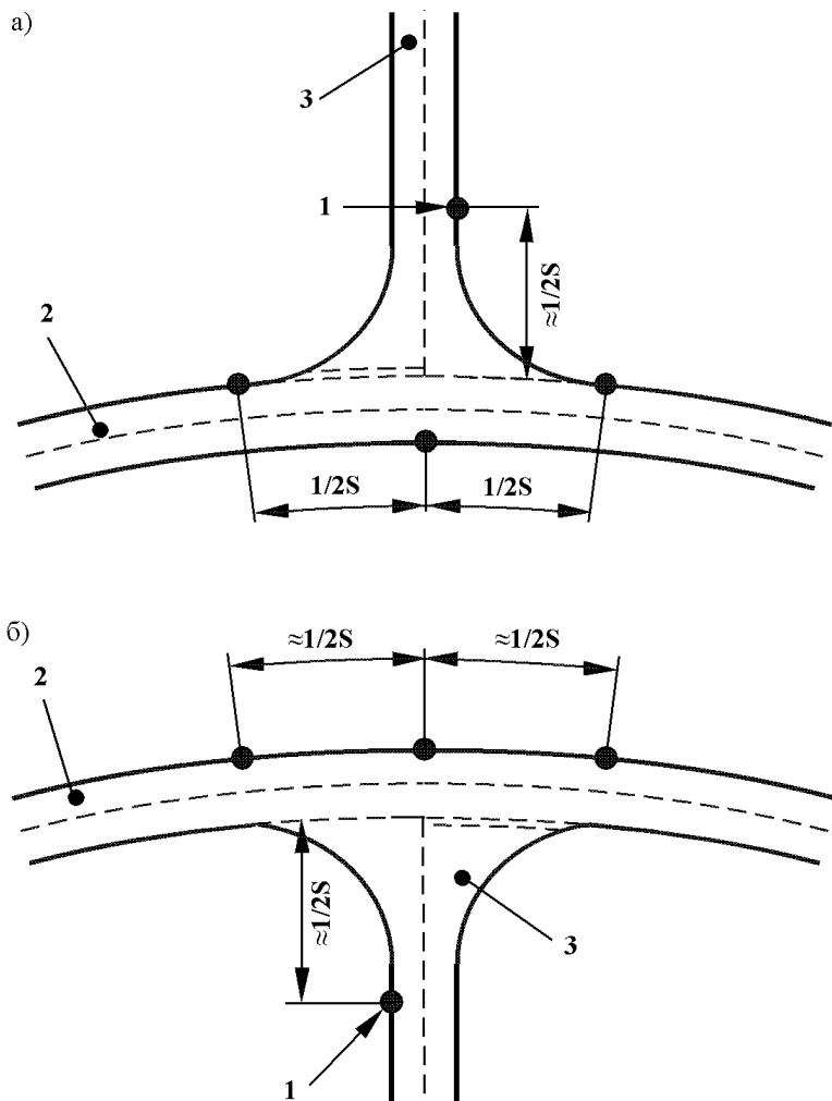
1 – положения светильников, 2 – главная дорога, 3 – второстепенная дорога, S – расчетный шаг установки светильников наружного электрического освещения вдоль главной дороги
